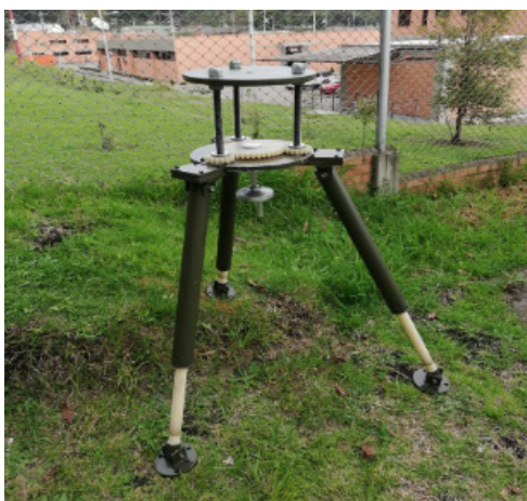
FIGURA 5. Diseño 2 – Soporte tipo trípode
