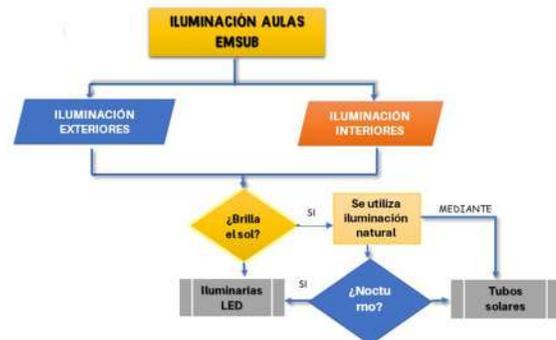
Figura 2. Tarazona. N (2018). Esquema de bloques luminaria salones EMSUB (Realización propia)
