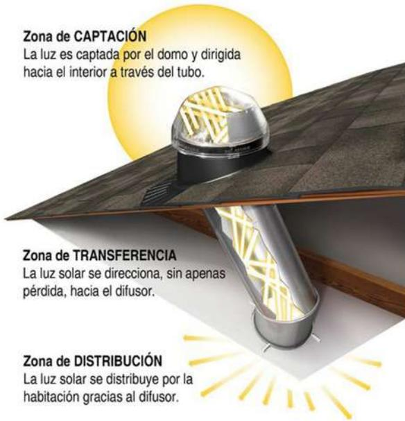
Figura 1. Esquema de un tragaluz tubular solar. Esquema recuperado de:
