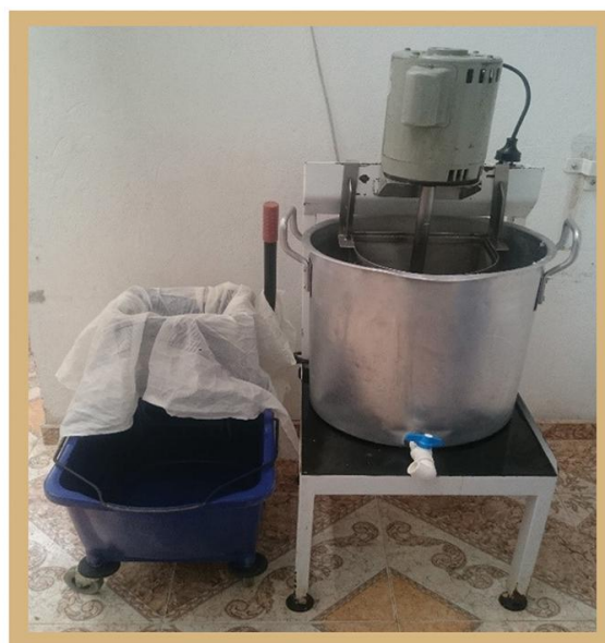
Figura 2. Equipo utilizado la separación de masa y leche de soya unidad productividad de Nilo.
